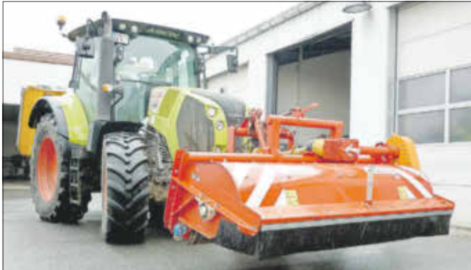
Angebauter Uni-Mulcher der Maschinenfabrik Drücker zum Mähen großer Flächen
