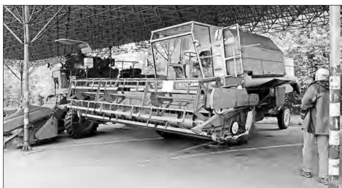
Ein Funktionsmuster des tschechischen Mähdreschers SM 500, der zugunsten des E 516 nicht in Serie produziert wurde.
